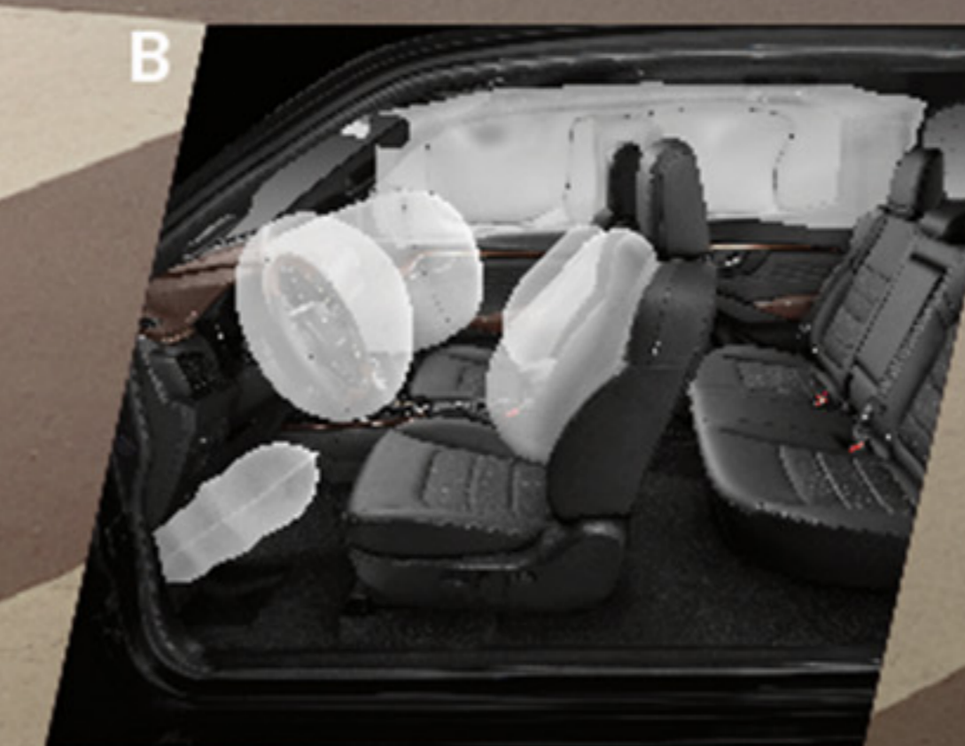
[B] Hệ thống túi khí: Biên dạng túi được mở rộng để bảo vệ tốt hơn.
